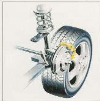
3. Das diagonale Zwei-Kreis-Bremssystem mit Scheibenbremsen vorne (14" bei Nexia GLX und GTX) und Trommelbremsen hinten bringt Sie auch bei Unerwartetem schnell zum Stehen. Mit dem serienmäßigen ABS bleibt die Lenkfähigkeit auch bei Vollbremsungen erhalten.
