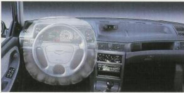
1. Der Fullsize-Fahrer-Airbag (60 Liter) in Verbindung mit angelegtem Sicherheitsgurt schützt Sie in Extremsituationen.
