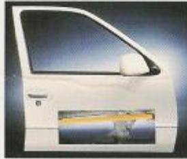
2. Zusätzlich zur selbsttragenden Sicherheitsfahrgastzelle sind Vorder- und Hintertüren mit 28 mm starken Verstrebungen versehen: Seitenaufprallschutz für alle Insassen.
