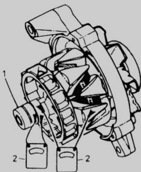
Rys. 7.9. Sprawdzenie uzwojenia wirnika alternatora 1 — łożysko, 2 — omomierz
