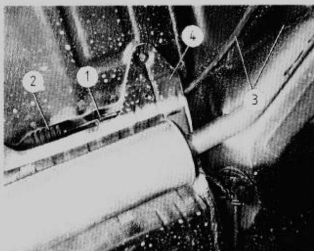
Rys. 6.23. Elementy regulacyjne hamulca awaryjnego 1 — nakrętka regulacyjna, 2 — osłona gumowa popychacza, 3 — linka hamulca awaryjnego, 4 — osłona termiczna tłumika
