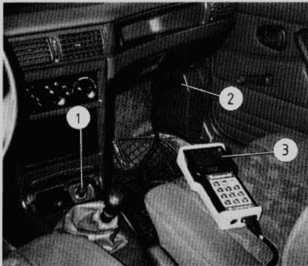
Rys. 7.26. Urządzenie diagnostyczne Scanner 11 1 — podłączenie przewodu zasilającego do gniazda zapalniczki, 2 — podłączenie przewodu sterującego do gniazda diagnostycznego ALDL, 3 — urządzenie diagnostyczne Scanner 11
