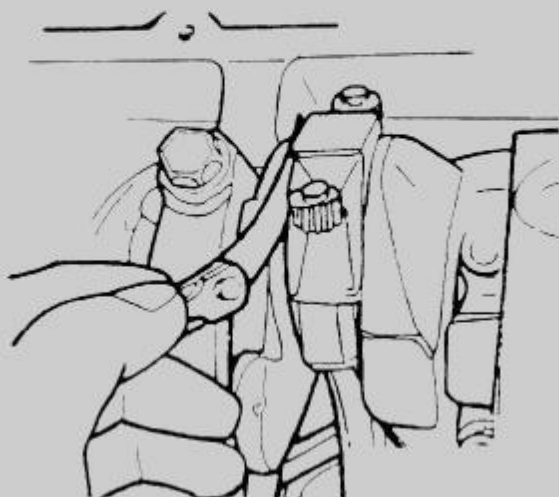
Rys. 1.55. Pomiar luzu bocznego korbowodu
