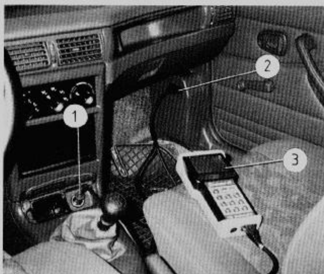
Rys. 6.25. Urządzenie diagnostyczne Scanner 11 1 — podłączenie przewodu zasilającego do gniazdka zapalniczki, 2 — podłączenie przewodu sterującego do gniazda diagnostycznego ALDL, 3 — urządzenie diagnostyczne Scanner 11
