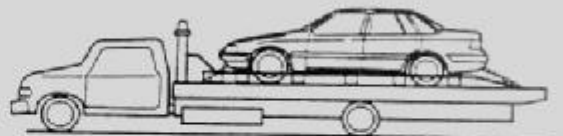
Rys. 0.13. Holowanie samochodu z wykorzystaniem sprzętu specjalistycznego
