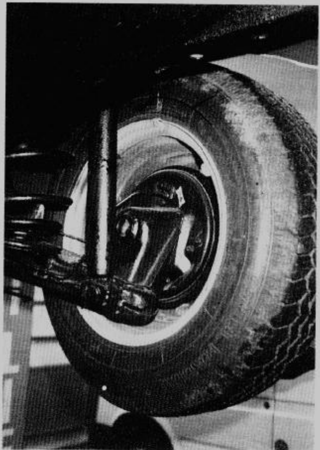
Rys. 5.10. Widok tylnego zawieszenia o osi tylnej z nie odkręcanym czopem piasty samochodu bez układu ABS
