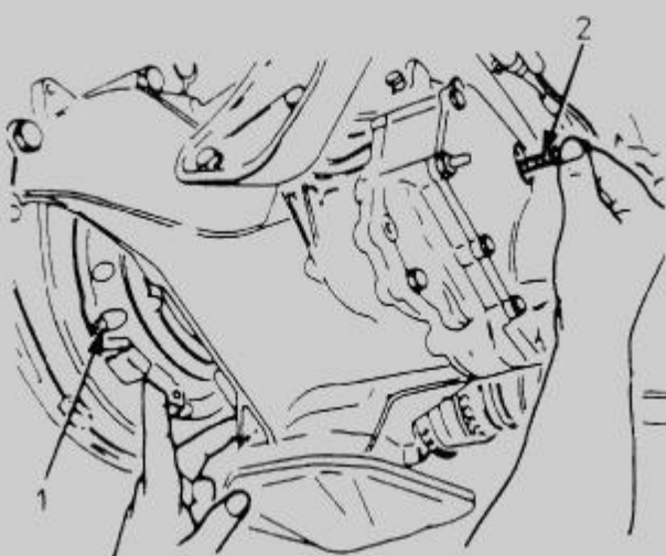
Rys. 2.9. Ustawienie tarczy sprzęgła w położeniu współosiowym
