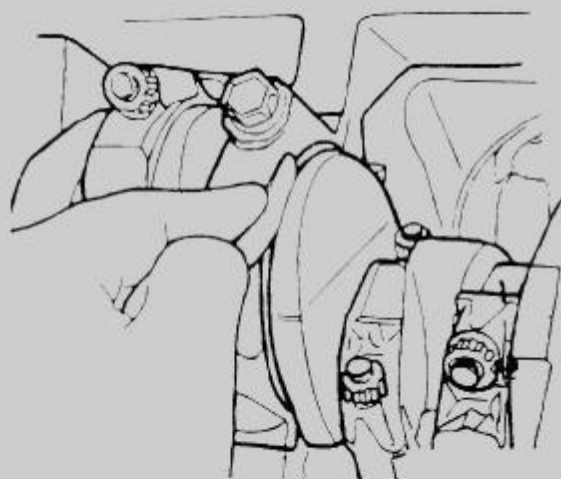
Rys. 1.54. Pomiar luzu osiowego wału korbowego
