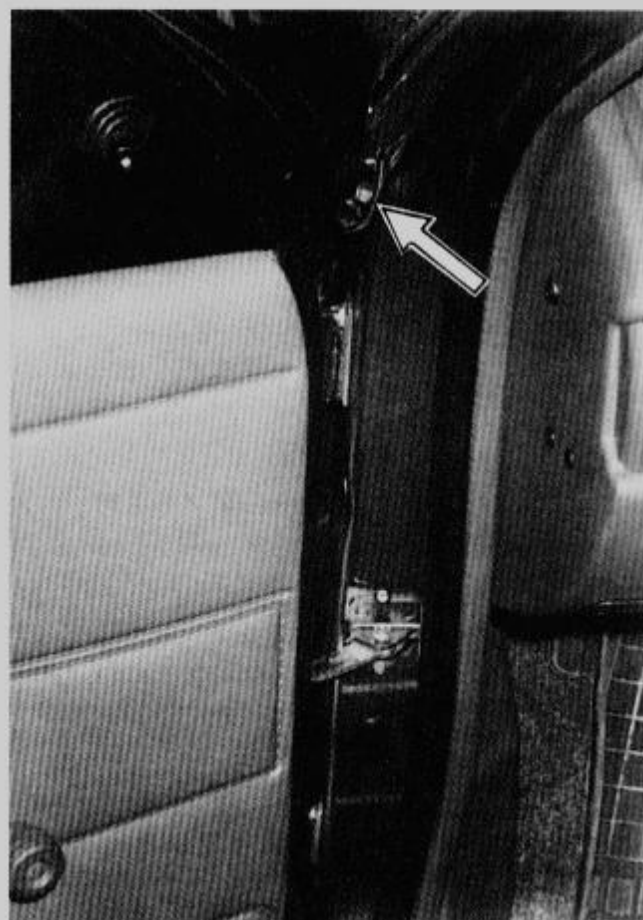
Rys. 8.10. Usytuowanie śruby mocowania błotnika przedniego do słupka drzwi
